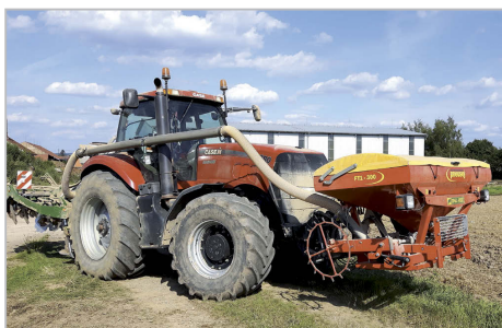
Secí stroj Simba DTX 300 zvládne pět operací najednou Foto archiv firmy
